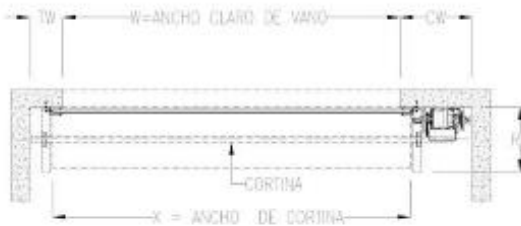
SECCIÓN A - A MONTAJE TIPO 1
